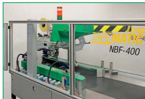
Verschließaggregat der NBF-400 für Selbstklebeband mit automatischer Deckelzufaltvorrichtung und optischer Anzeige.
